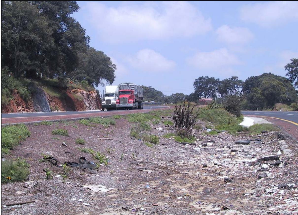
**Figura 8. Sitio donde se detienen los vehículos que se salen por falta de continuidad en la barrera metálica en una curva**
