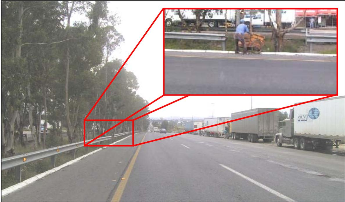
**Figura 4. Discontinuidad en una barrera metálica lateral**
