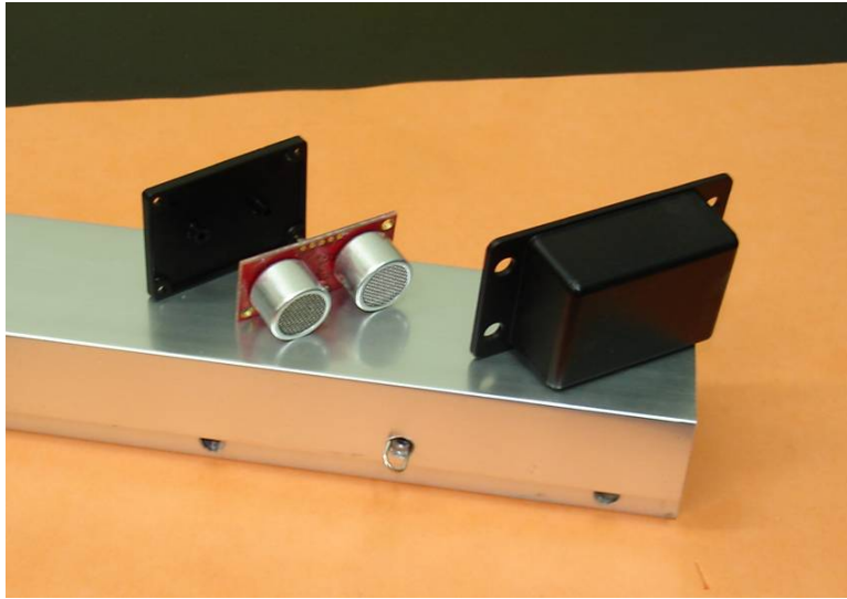
Fig. 5. Vista del módulo SFR08 utilizado en el proyecto
