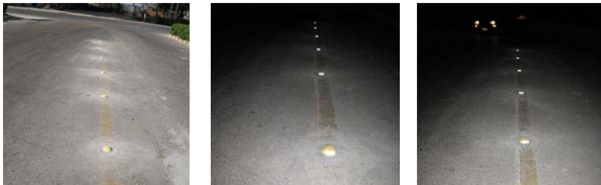
Fig. 2. Visibilidad diurna y nocturna de los prototipos de catafaros elaborados.
