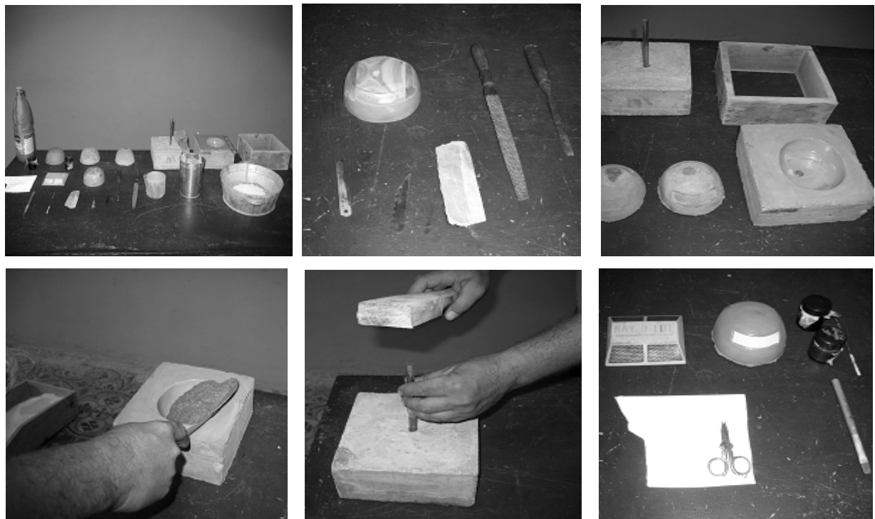
Fig. 1. Materiales, moldes, proceso de elaboración y prototipos de catafaros.
