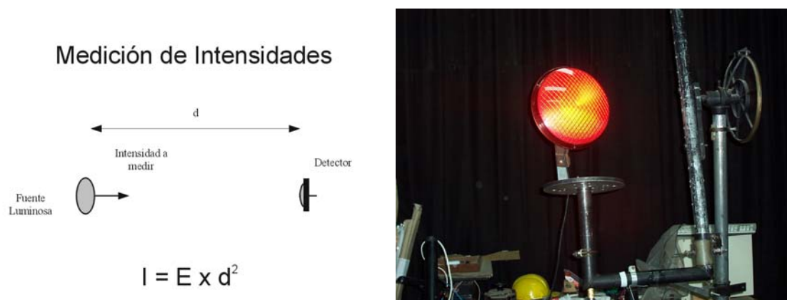
Figura 7. Medición de las intensidades luminosas en goniofotómetro.
