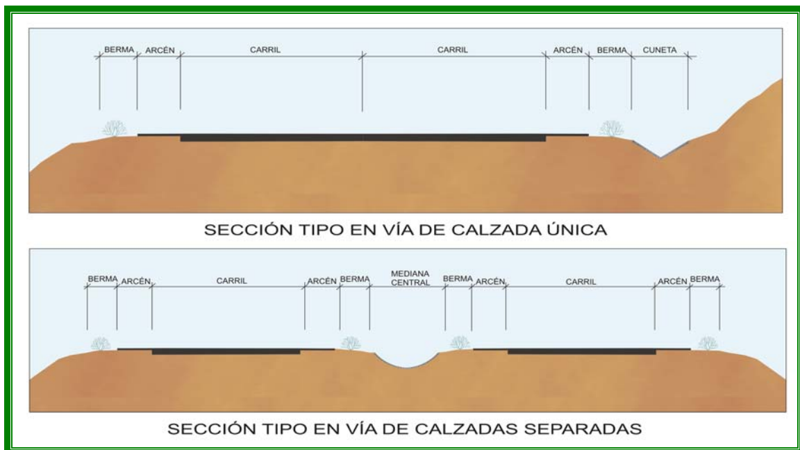
Fig. 1 – Secciones Transversales Normales de una carretera con Vía Única y de una carretera con Vías Separadas
