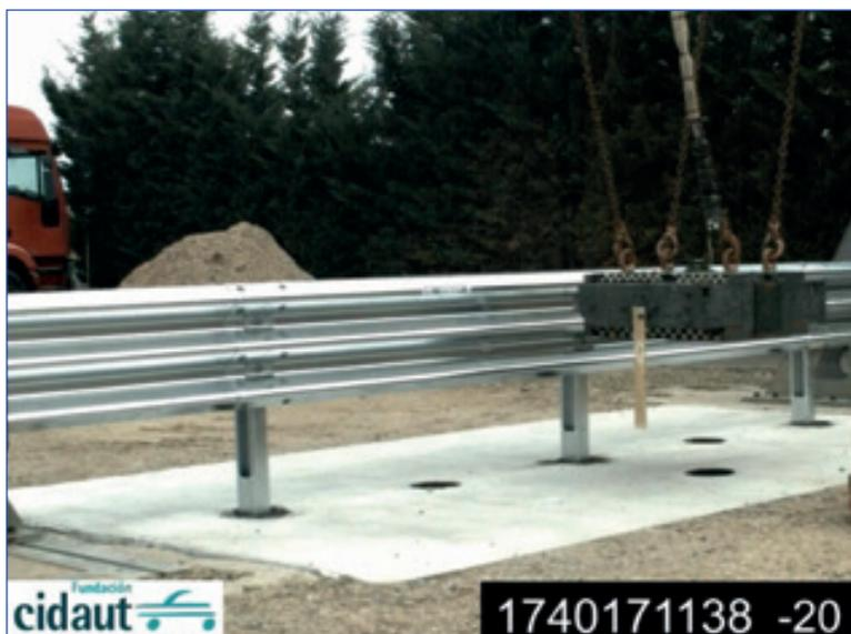
Figura 7. Imagen de un ensaño dinámico de péndulo.
